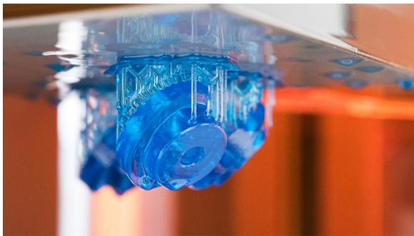
Les porte-pièces sont fabriqués par lots, en résine Haute résistance Formlabs.
