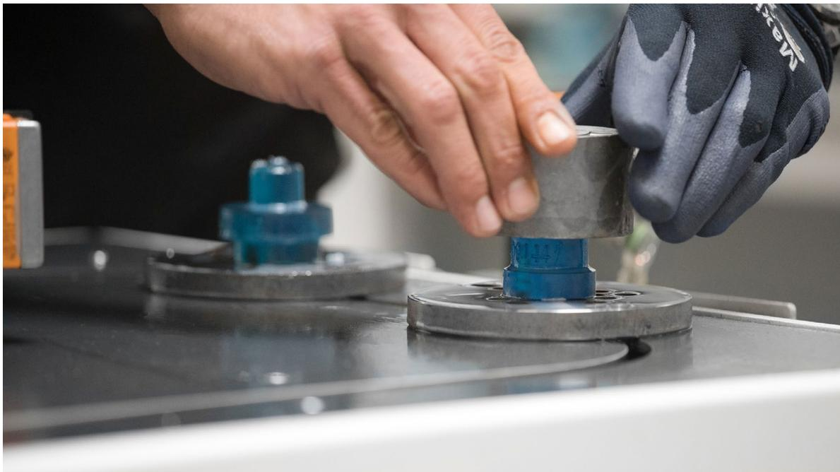
Chaque phase de tournage automatisé requiert un porte-pièce spécifique. Le porte-pièce est fixé sur une navette, sur le convoyeur.
