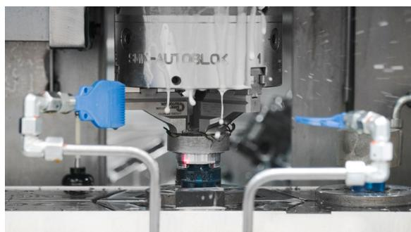
La machine prend la pièce placée sur le premier porte-pièce et la pose sur le second une fois l'usinage réalisé.
